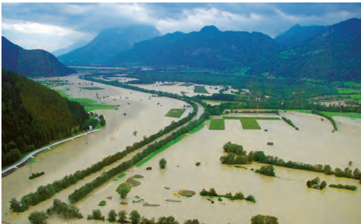
Abb. 10: Bei Hochwasser überflutete Retentionsräume halten große Wassermengen zurück, bremsen so das Hochwasser und bewahren flussab gelegene Siedlungen vor Schäden.
